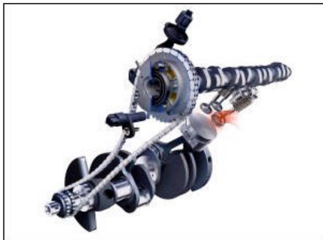
Gli organi che consentono di ottenere questo movimento di apertura/chiusura delle valvole in sincronia con la rotazione del motore, prendono il nome di punterie, bicchierini, e molle. In pratica, il movimento di rotazione dell'albero a camme, ed in modo particolare i suoi eccentrici, permette di vincere la resistenza delle molle di richiamo, consentendo così il movimento alternato delle valvole.
