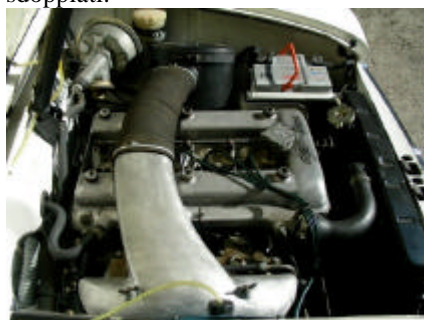
Il bialbero 1600 in alluminio con la vistosa "proboscide" che porta l'aria dal filtro ai due carburatori doppio corpo.
