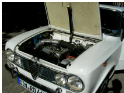
Cofano motore. Notare la parte superiore dello scudo mancante, poiché solidale al cofano.
