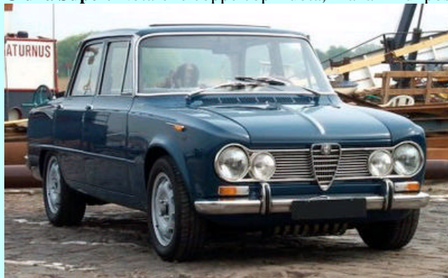
Giulia TI. La vettura si presenta in modo molto più spartano rispetto alla Super. Manca la modanatura sottoporta, le coppe sulle ruote, ed i fanalini di posizione presentano la colorazione arancione in corrispondenza degli indicatori di direzione.
