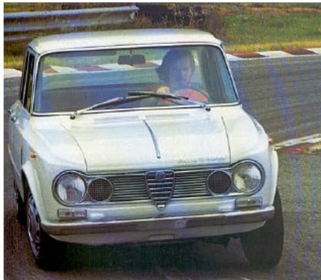
I rostri gommati della TI sono scomparsi. I due fari interni sono stati rimossi e sostituiti da una retina per l'accesso dell'aria ai carburatori. Compare la scritta TI Super sul bordo del cofano.
