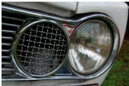
Il falso gruppo ottico sostituito con una griglia di presa d'aria
